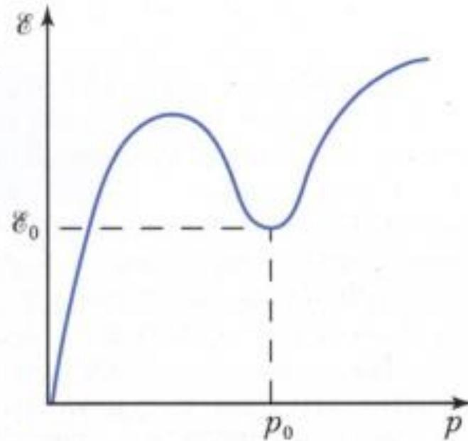
Спектр элементарных возбуждений в He II, полученный в нейтронных экспериментах;  $\varepsilon$  – энергия квазичастицы,  $p$  – её импульс.
